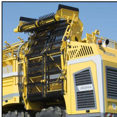
Entladebandknickteil 1 und 2 in Rodestellung
