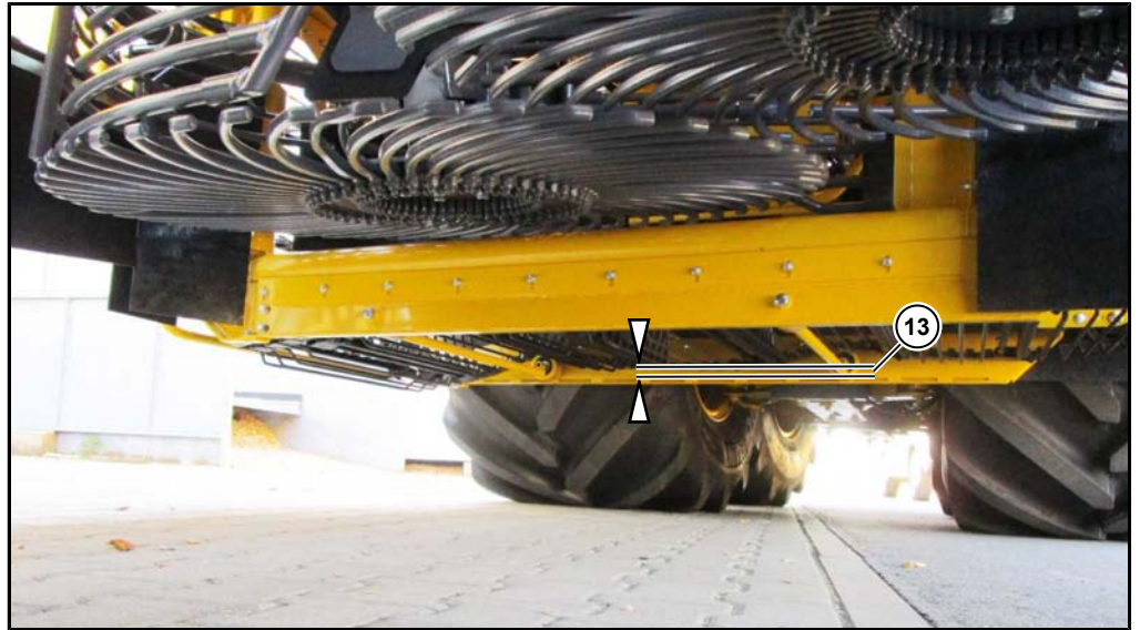
Elevatorband richtig gespannt
