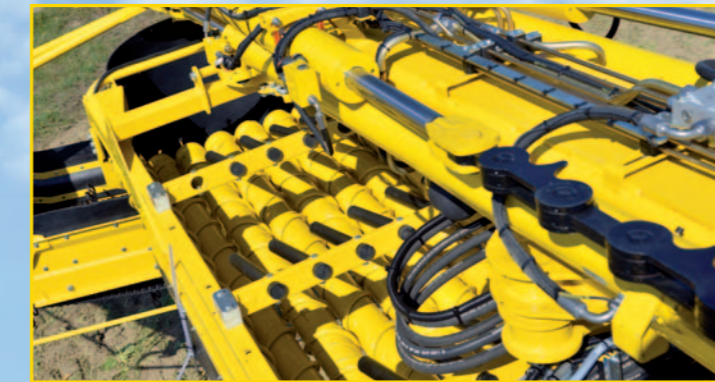
Zwickwalzenreiniger mit Rübenbremse (optional)
