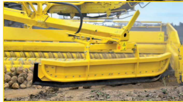
Robuster Restrübenaufnehmer mit abgewinkelten Ecken, proportional ansteuerbar
