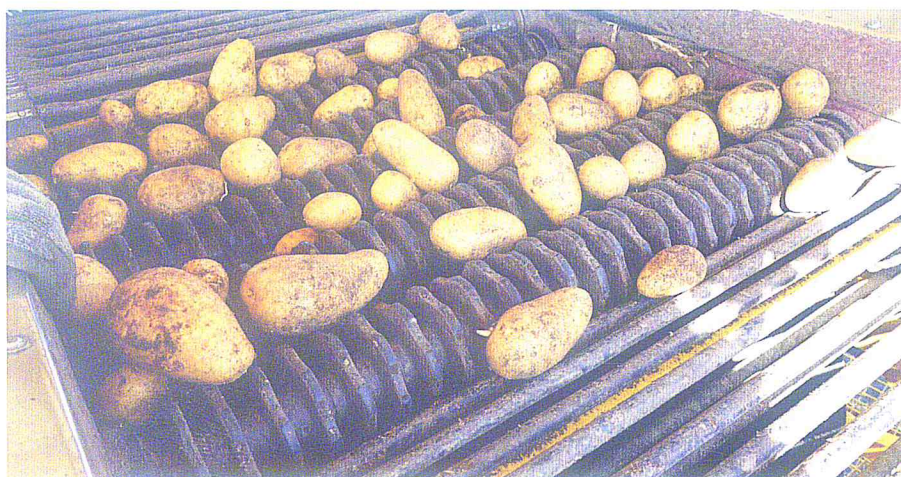
Der Verlesetisch mit fünf Kalibrierwalzen bietet für bis zu sieben Personen einen hohen Arbeitskomfort.
