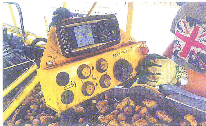
An der «Premium»-Bedienung kann das Verlesepersonal sämtliche Einstellungen der Maschine selber beeinflussen.
