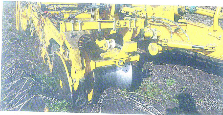
Die Aufnahme ist mit elektronisch gesteuerter Dammtrommellenkung und einer Dammdruckregelung ausgerüstet.
