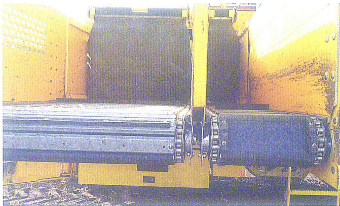
Der Doppelbunker bietet sechs Tonnen Kapazität, wovon ein Viertel für den Abgang abgetrennt ist.
