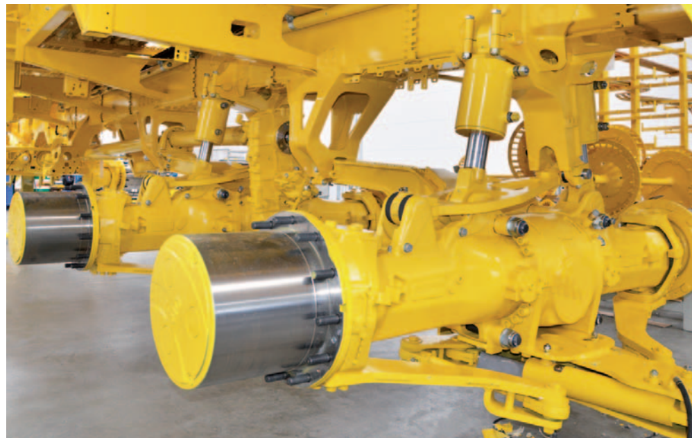
Hydraulisches Fahrwerk, automatischer Hangausgleich
