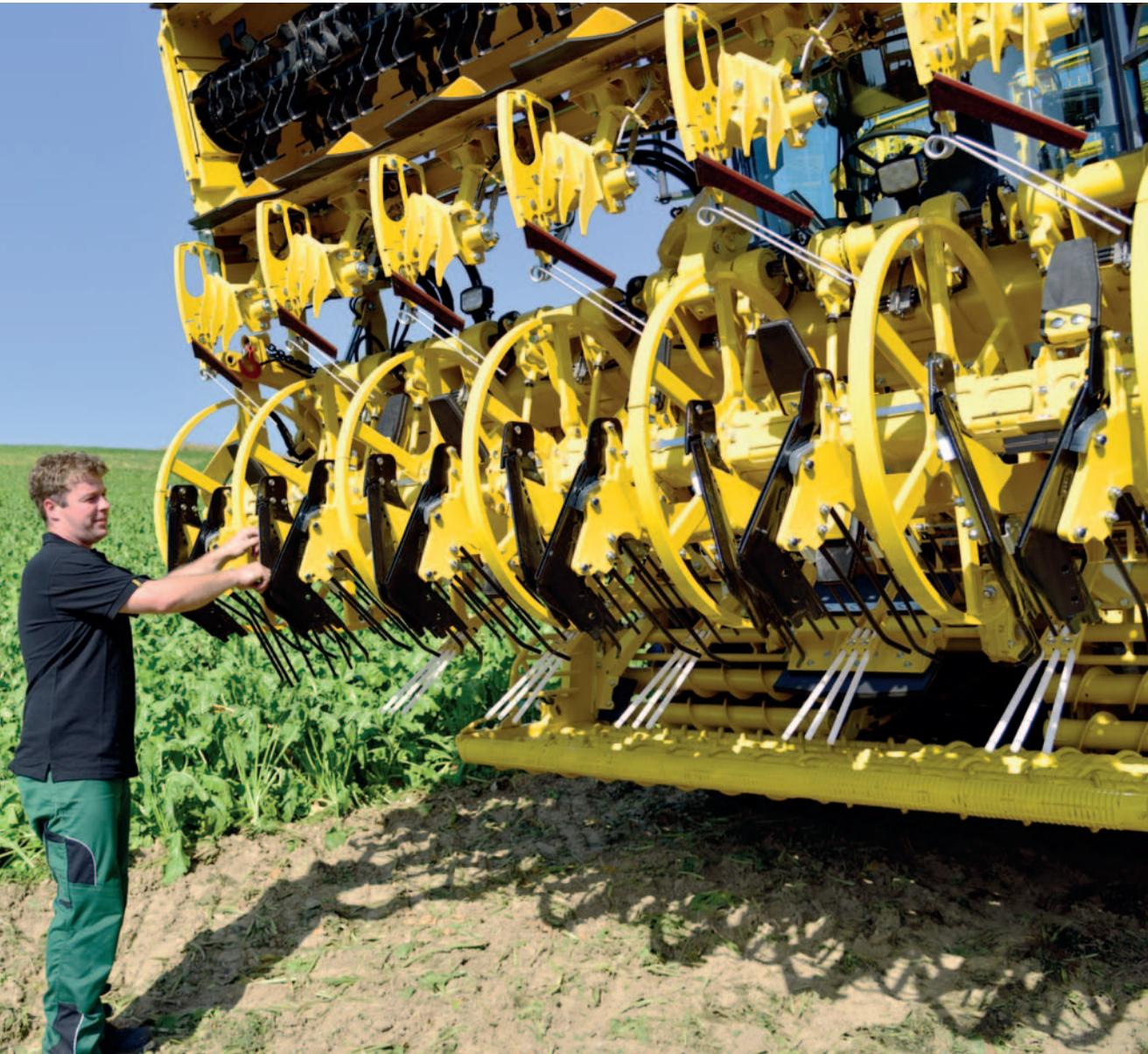
Per Knopfdruck am Roder kann der Motor gestartet werden, um im Anschluß die gewünschte Wartungsposition einzustellen.
