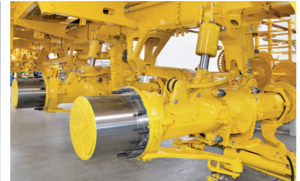
Hydraulisches Fahrwerk, automatischer Hangausgleich
