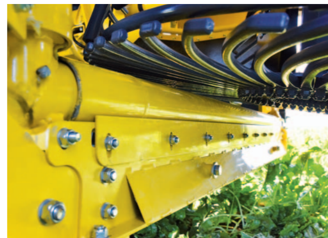
Drehende Übergangsröhre am Elevatoreinlauf verhindern Erdaufbau
