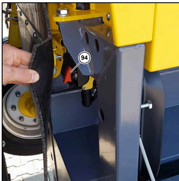
Stromversorgung am Notschalter eingeschaltet
