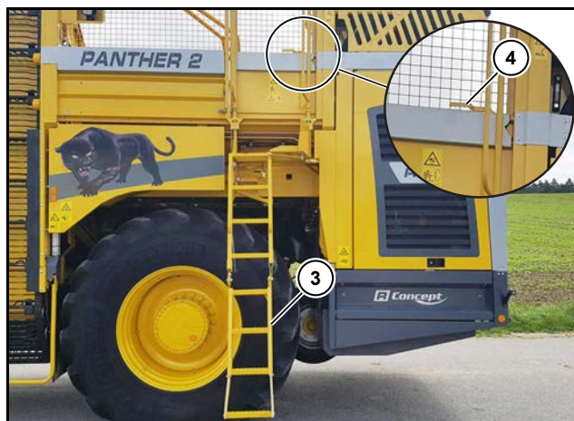
Bunkerleiter und Plattform aufstiegsbereit
