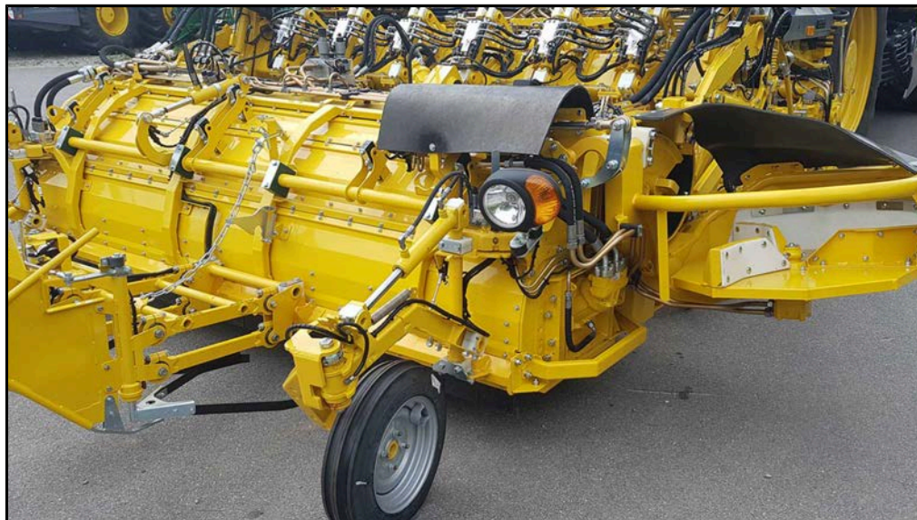
RASW-Schlegler, Schleglerklappe oben
