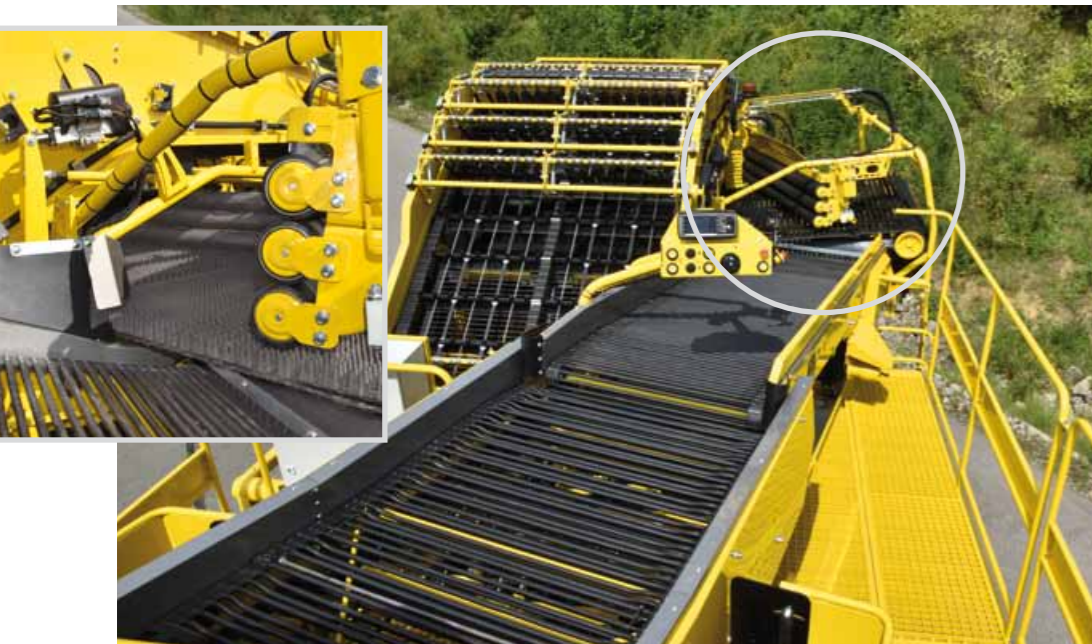
Keiler 2 Classic mit Dreifach-Ableitwalzen
