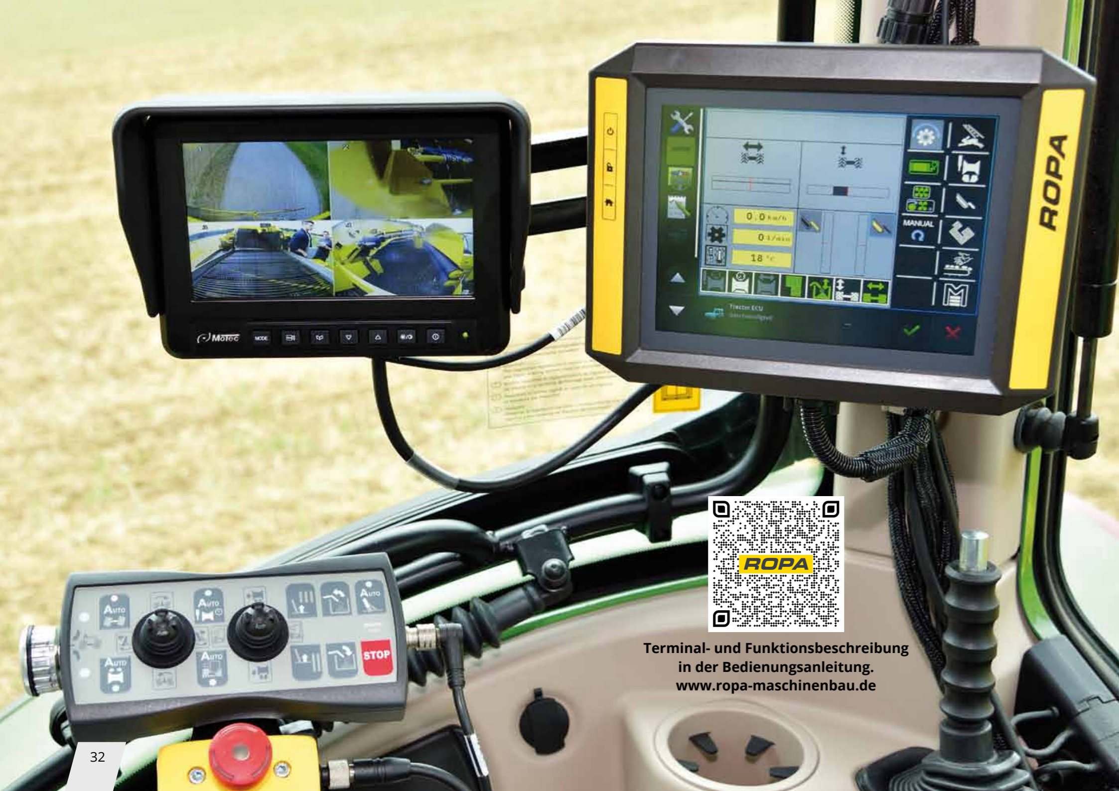
Bedienelement nach ISOBUS AUX-N Standard, komplett frei belegbar
