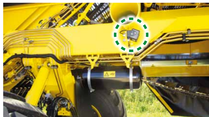
Zusatzkameras für Siebkette, Krautkette, Igel, Verlesetisch, Bunker und Rückfahrkamera
