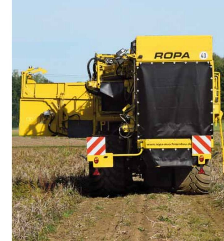
Fahrgassenrodung mit eingeschobener Teleskopachse - kein Überfahren des Kartoffeldammes
