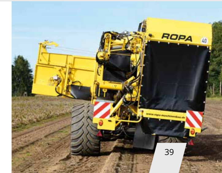
Serienmäßiger hydraulischer Hangausgleich - optimierte Reinigung und mehr Komfort für das Verlesepersonal
