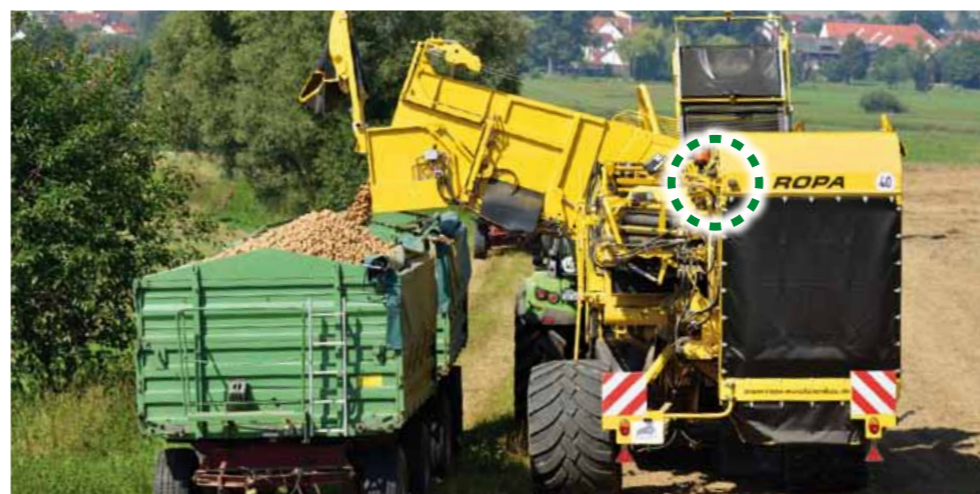
Zusatzkameras für Siebkette, Krautkette, Igel, Verlesetisch, Bunker und Rückfahrkamera
