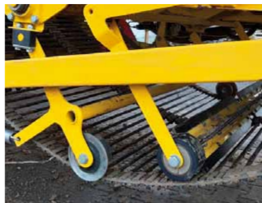
Siebkettenspanner mit separater, ausschwenkbarer Reinigungswalze
