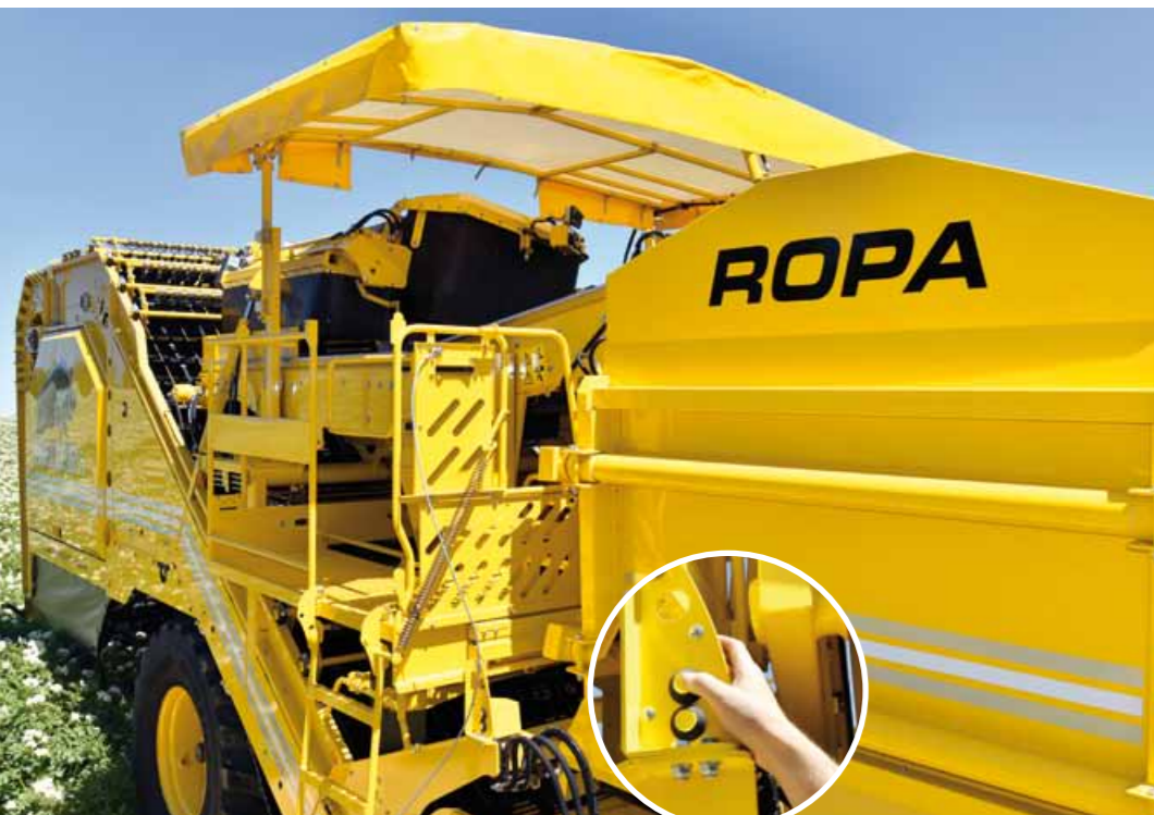
Sonnenschutzdach, höhenverstellbar (optional, erweiterbar um Seitenverkleidung)
