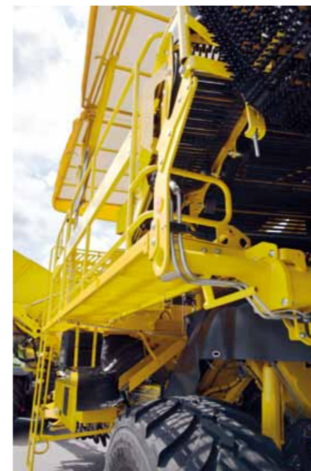
Ausschwenkbarer Verlesestand für noch größeres Platzangebot
