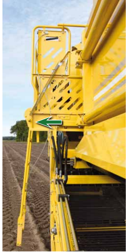
Arbeitspodest, 300 mm ausschiebbar - großzügige Arbeitsfläche für mehr Bewegungsfreiheit
