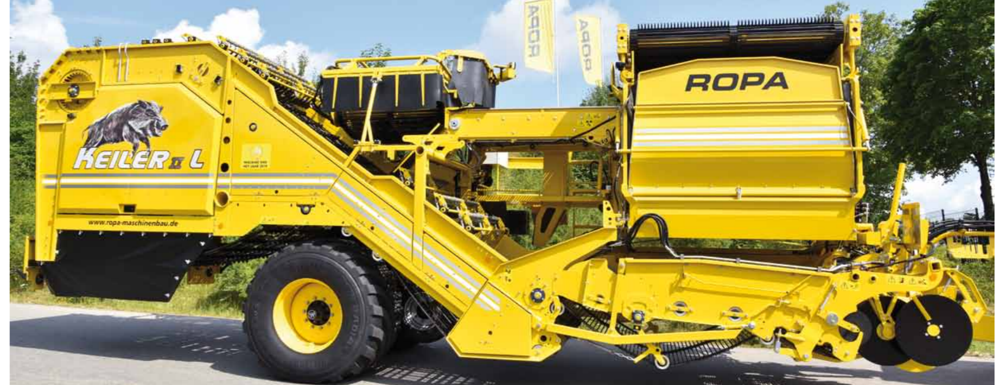
Keiler 2 L 4-Igel ohne Beimengenband und ohne Verlesestand rechts
