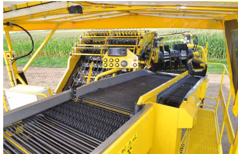
Keiler 2 Classic mit UFK, Beimengenspur und Sortierwalzen
