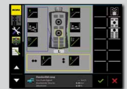
Bedienelement links Überladebunker default-Belegung 2
