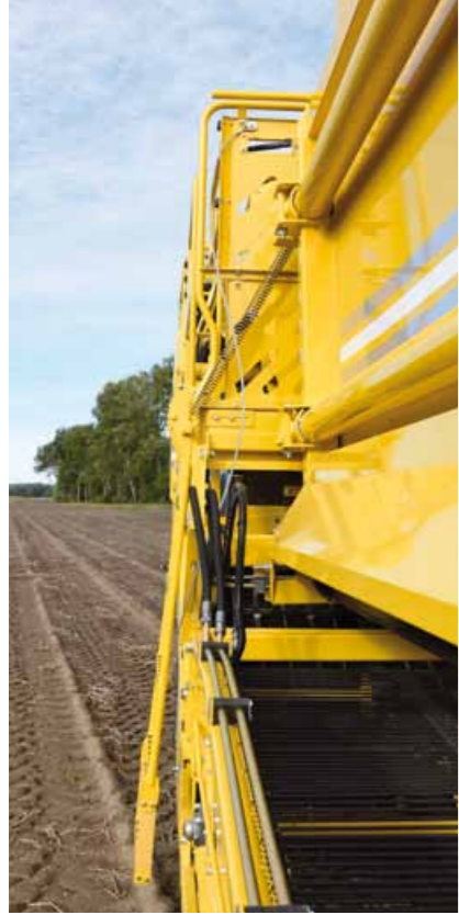
Arbeitspodest, 300 mm ausschiebbar - großzügige Arbeitsfläche für mehr Bewegungsfreiheit
