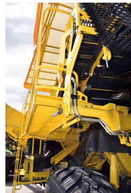
Ausschwenkbarer Verlesestand für noch größeres Platzangebot
