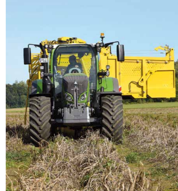
Fahrgassenrodung mit eingeschobener Teleskopachse - kein Überfahren des Kartoffeldammes
