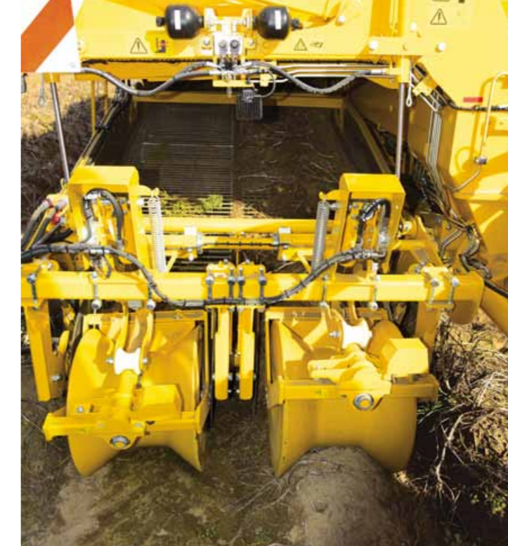
Fahrgassenrodung mit eingeschobener Teleskopachse - kein Überfahren des Kartoffeldammes
