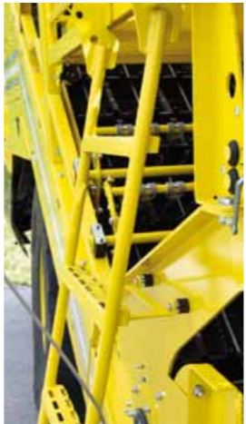
Klappbare Leiterdämpfung für einen sicheren Aufstieg
