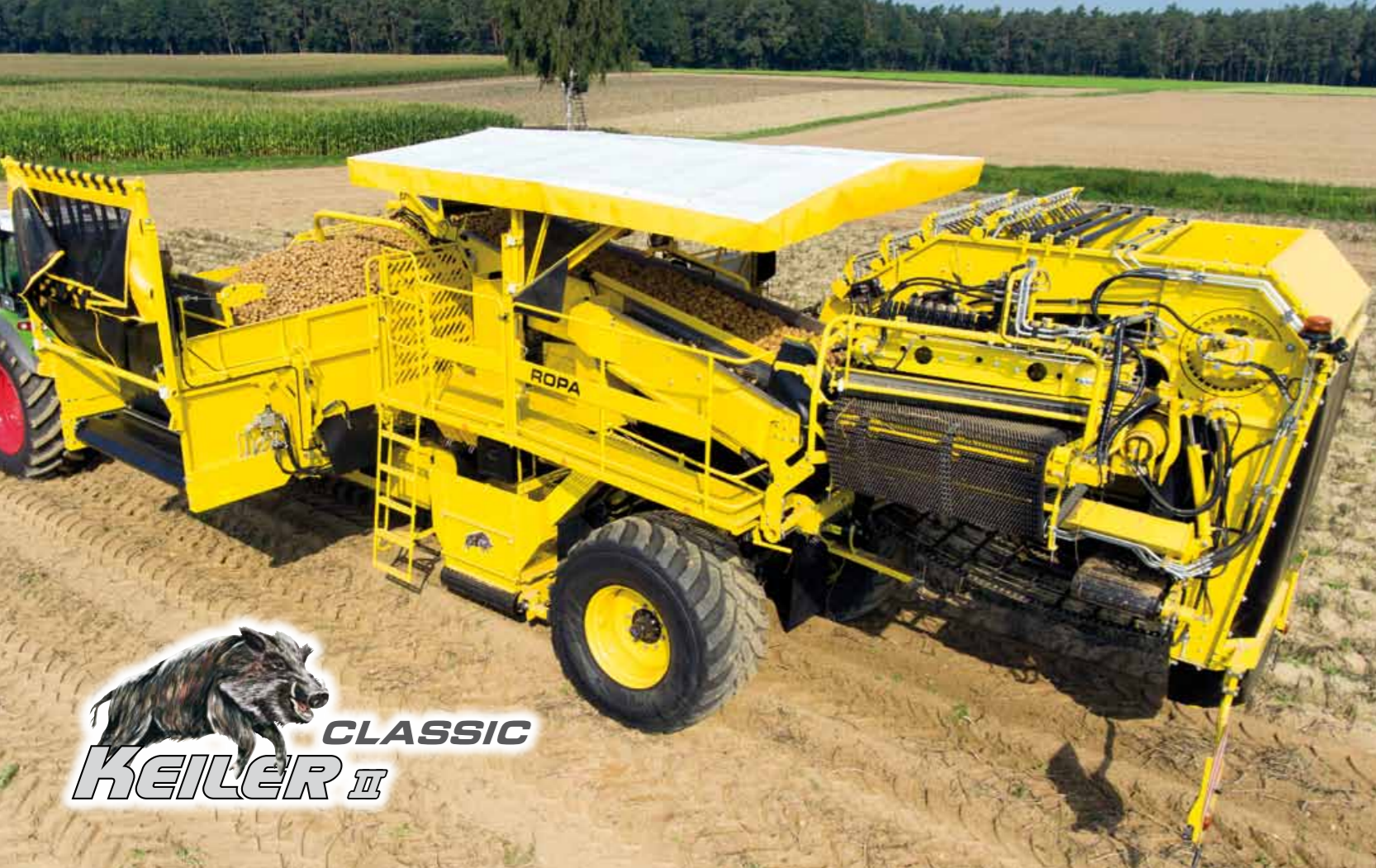
Ausschwenkbarer Verlesestand für noch größeres Platzangebot
