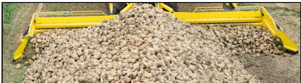
Falsche Einstellung der Räumschilder. Sinnloser Erdhaufen im Bereich der Räumschilder. Zusätzlich falsches Fahren an der Miete. Diese sollte möglichst mittig angefahren werden.
