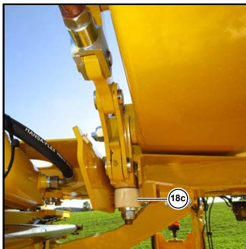
Verriegelung Gegengewichtsarm geschlossen
