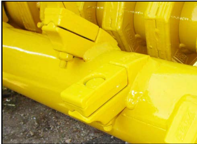
Aufnehmerfinger mit Verschleißplatte
