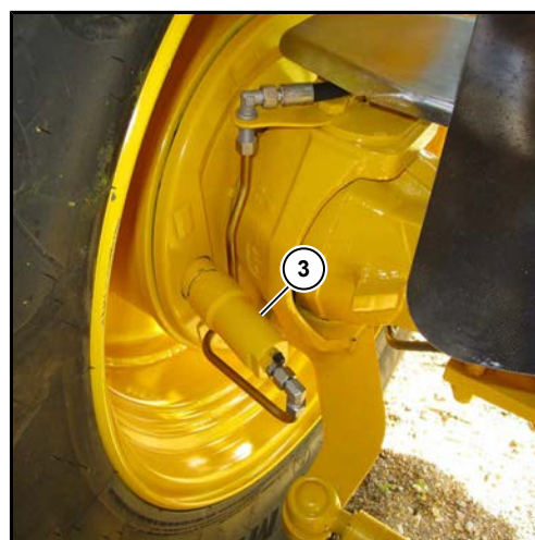
(3) Hinterachse mit hydraulisch betätigter Trommelbremse
