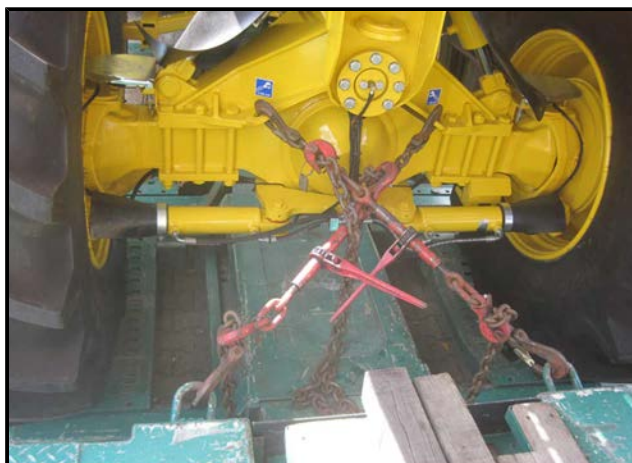
Verzurrpunkte am Hinterachsbock
