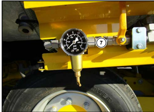
(7) Druckminderer für die Wassersprühanlage
