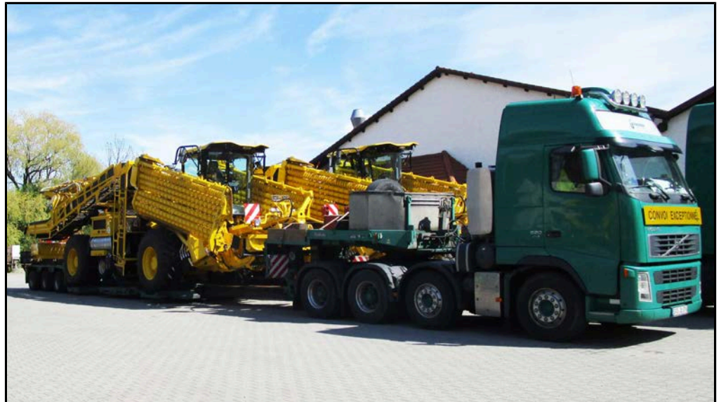
Ordentlicher Tieflader für Straßenverkehr mit Minimaltransporthöhe
