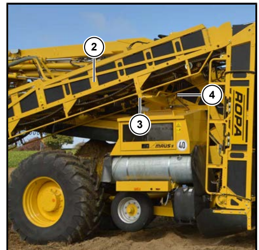
Überlader korrekt auf der Transportstütze abgelegt.
