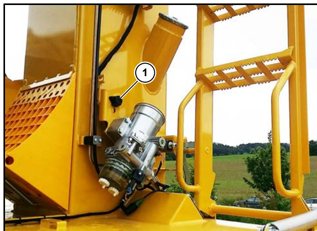
(1) Steckdose am Kraftstofftank
