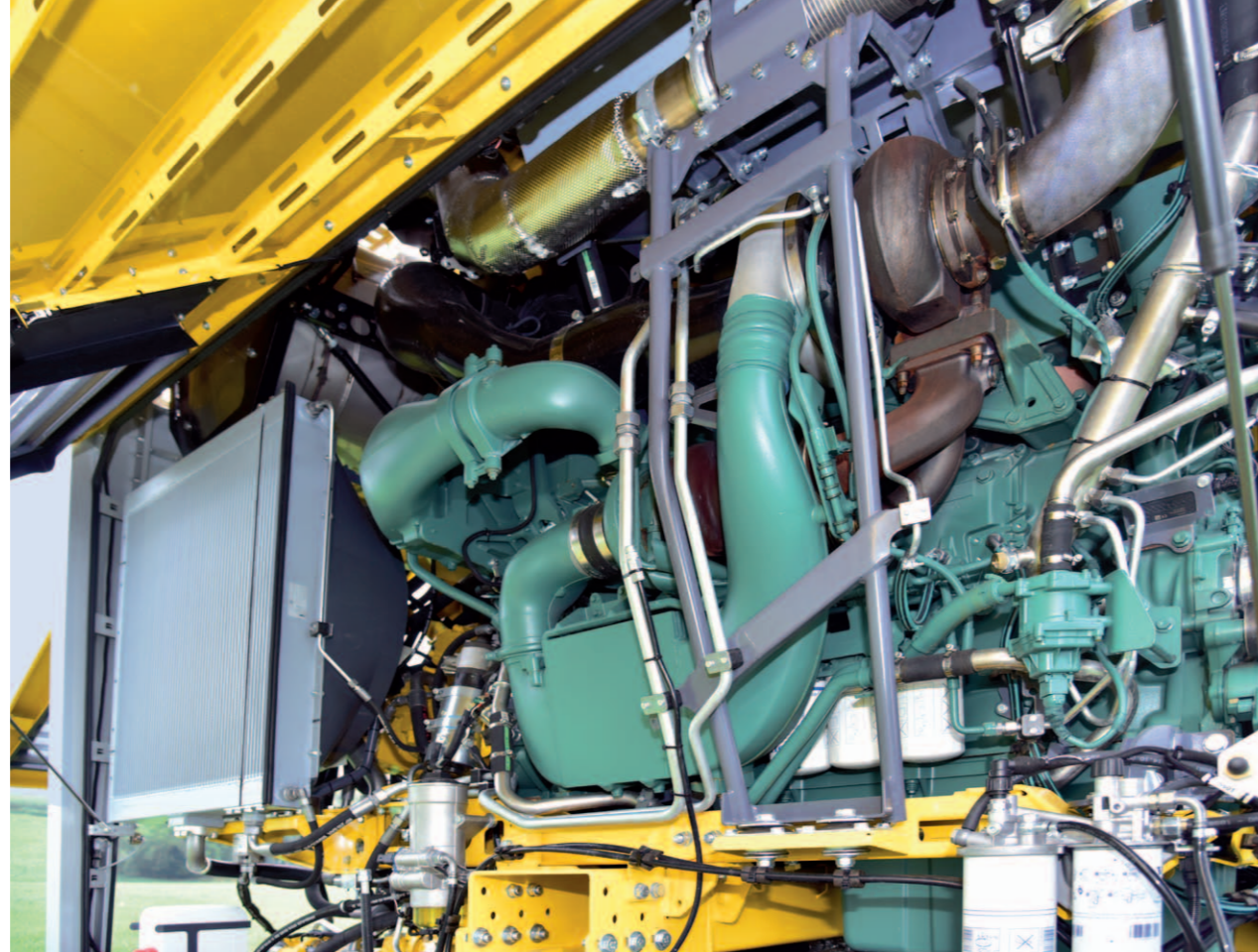
Volvo Penta TWD1683VE - die Basis für höhere Tagesleistungen bei weniger Kraftstoffverbrauch, noch mehr Kraft bei niedrigen Drehzahlen.
