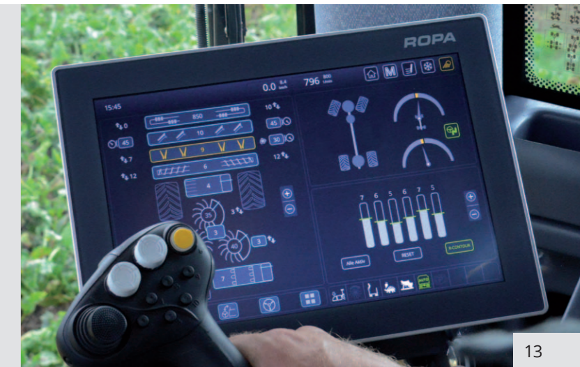
Automatische Schartiefenverstellung bei unebener Bodenkontur Ultraschallsensoren neben jeder Rübenreihe erfassen die Bodenoberfläche
