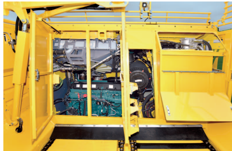
Volvo Penta TWD1683VE - die Basis für höhere Tagesleistungen bei weniger Kraftstoffverbrauch, noch mehr Kraft bei niedrigen Drehzahlen.
