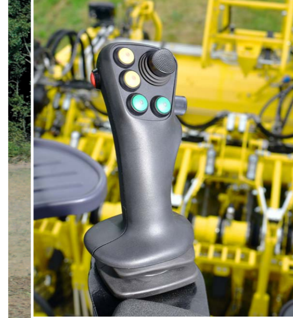
Bedienelement an der linken Armlehne zur feinfühligsten Steuerung der Bunkerentleerung
