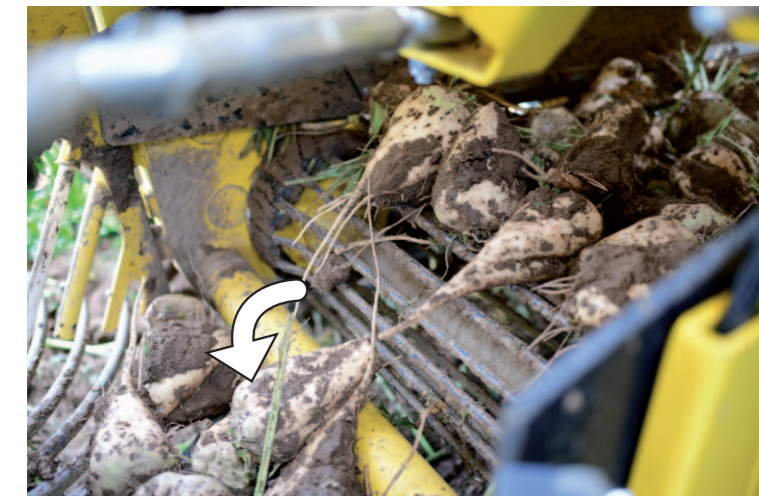
Drehendes Übergangsrohr am Siebsterneinlauf verhindert Erdaufbau
