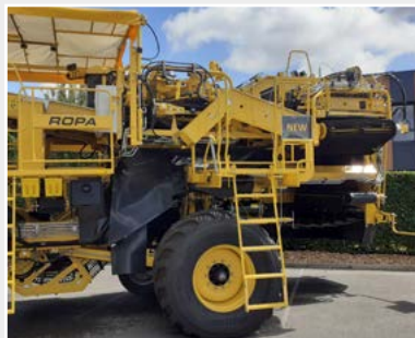
Den Keiler 2 gibt es mit einer neuen Beimengentrennung; erstmals mit zwei Fingerkämmen hintereinander.
