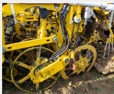
Für die Tiger und Panther nimmt Ropa als Option das Radrodeschar ins Programm auf.
