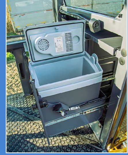
In die Kabinenrückwand ist serienmäßig eine Kühlbox integriert.
