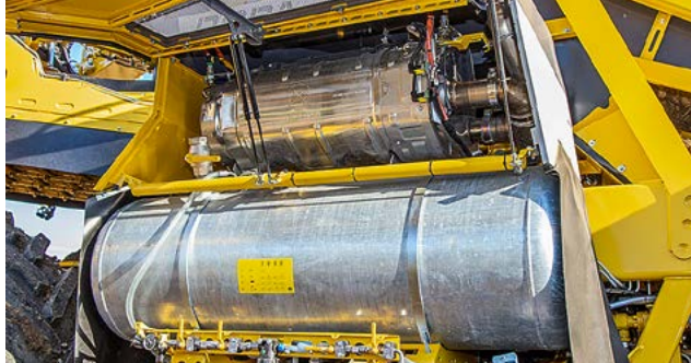
Abgasreinigung mit SCR und Partikelfilter (oben) sowie ein 400 l Tank für die Sprüheinrichtung (unten).
