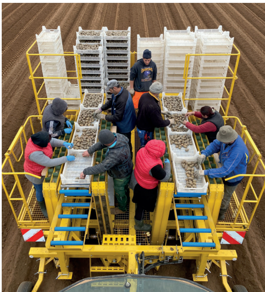
Auf der neuen Handpflanzmaschine Gecko von Ropa arbeiten die Mitarbeiter im Stehen. Die Greifwege sind kurz. Im hinteren Bereich ist Platz für bis zu 220 Kisten.
