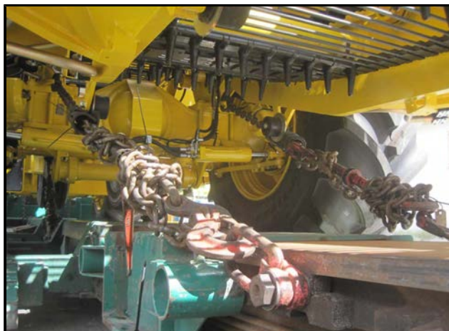
Verzurrung an der Vorderachse
