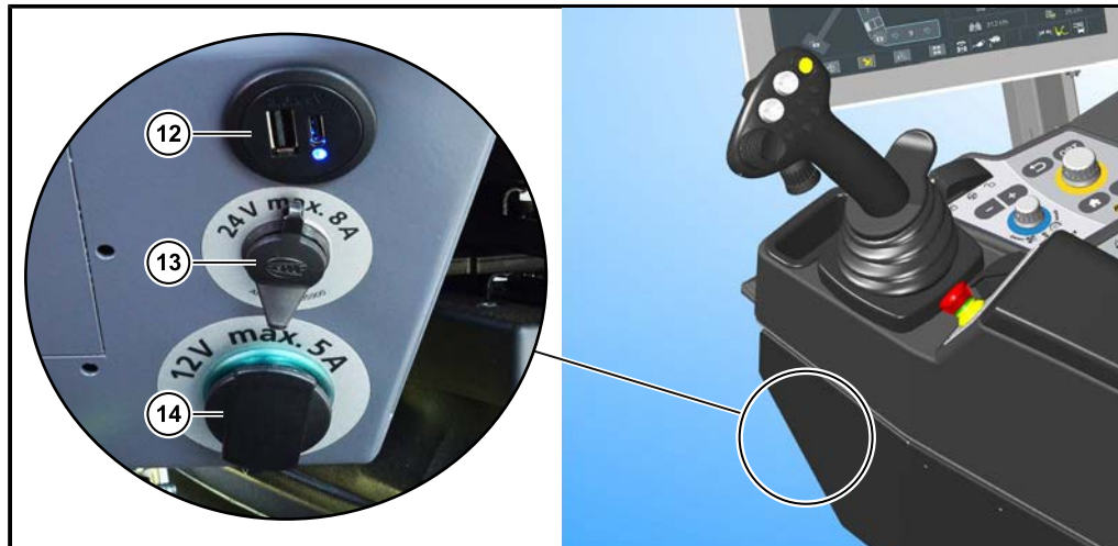
Steckdosen an der Vorderseite der Bedienkonsole
