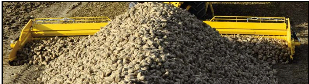
Optimale Einstellung der Räumschilder (Bild von Vorgängermodell Maus 5)
