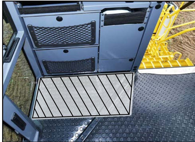
Nicht beheizter Bereich der Fußbodenheizung
