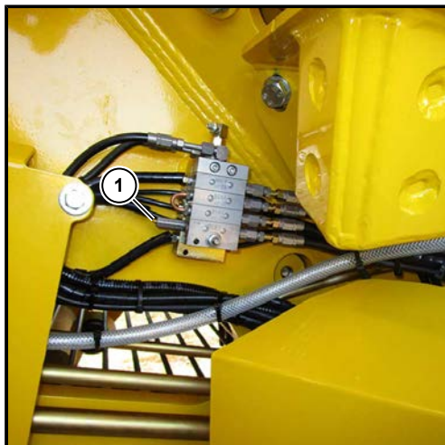
Hauptverteiler Aufnahme (rechte Seite Aufnahmemittelteil)
