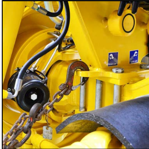
Verzurrpunkt hinter der Vorderachse links
