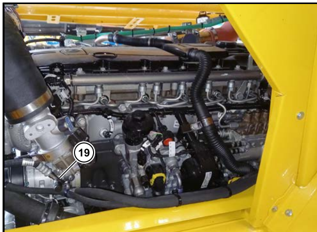
(19) Wartungsanschluss am Klimakompressor
