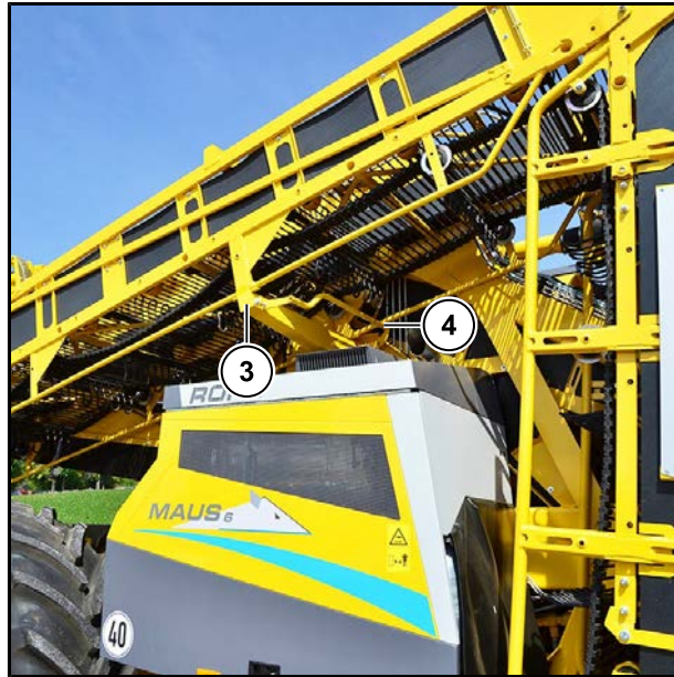
Überlader korrekt auf der Transportstütze abgelegt.
