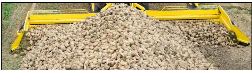
Falsche Einstellung der Räumschilder. Aufschieben von Erdreich im Bereich der Räumschilder. Zusätzlich falsches Fahren an der Miete. Diese sollte möglichst mittig angefahren werden. (Bild von Vorgängermodell Maus 5)
