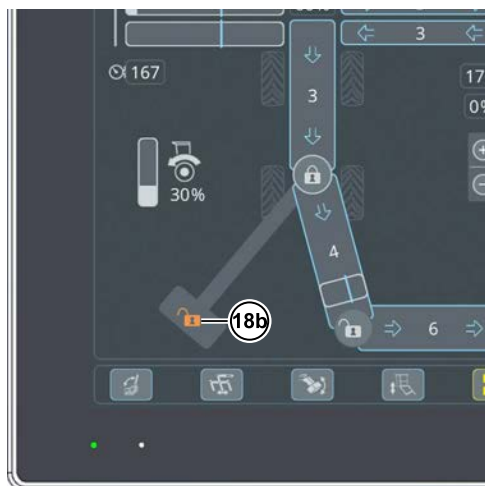
Verriegelung Gegengewichtsarm in Anschlagstellung
