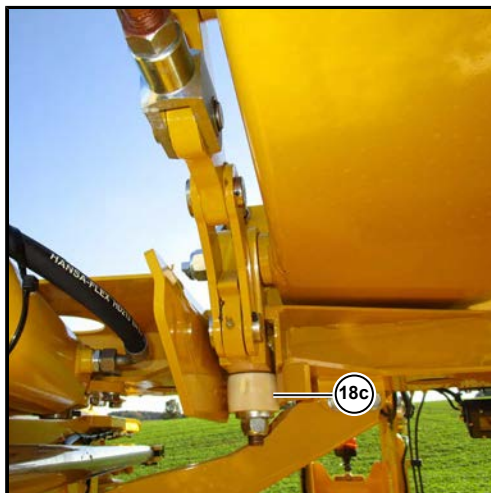
(18c) Verriegelung Gegengewichtsarm geschlossen
