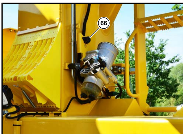
(66) Steckdose am Kraftstofftank 24V / 8A maximal
