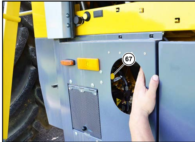
(67) Taster für die Aufstiegsbeleuchtung an der Maschine
