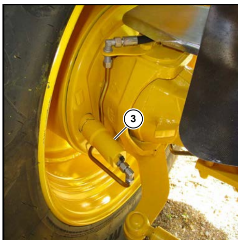
(3) Hinterachse mit hydraulisch betätigter Trommelbremse
