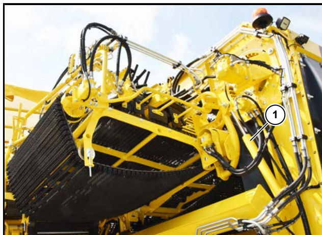
(1) Zylinder Igelband 1/2 Neigung
