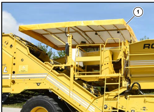
(1) Sonnenschutzdach in Arbeitsstellung
