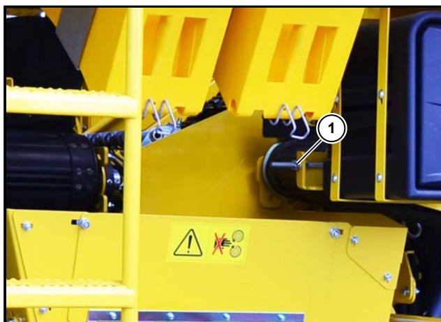
(1) Spanner Zuführband Kartoffelquetsche links
