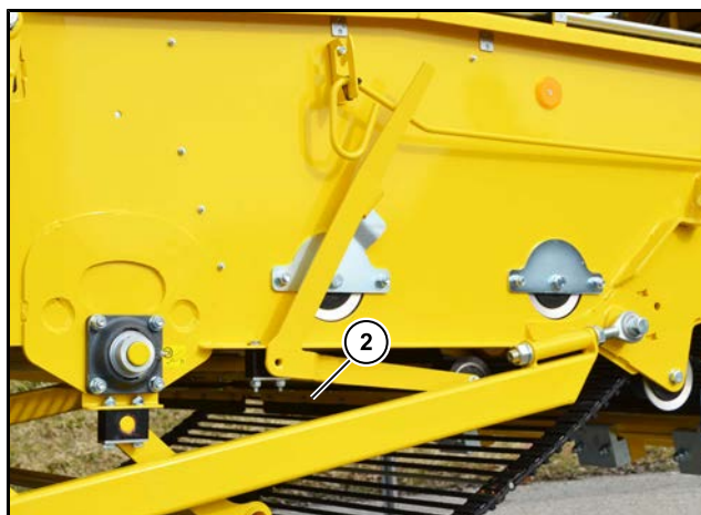
(2) Reinigungswalze Siebkette 1 ausgehängt ab Bj. 2021
