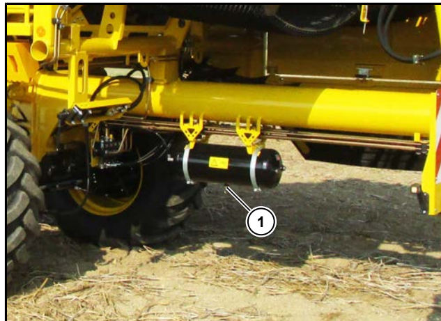
(1) Druckluftbehälter mit Ablassventil
