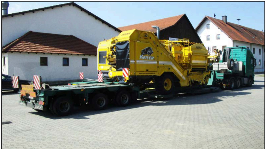
Ordentlicher Tieflader für Straßentransport mit Minimaltransporthöhe
