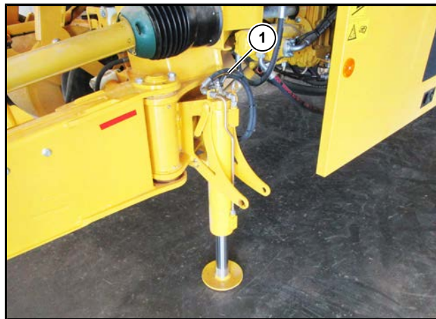
(1) Absperrhahn Stützfuß geschlossen
