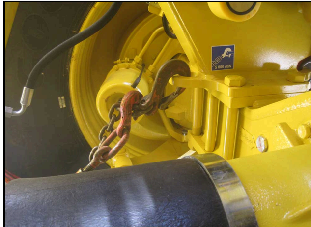
Verzurrpunkt hinter der Vorderachse links
