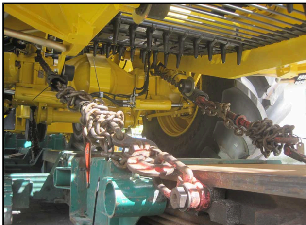
Verzurrung an der Vorderachse
