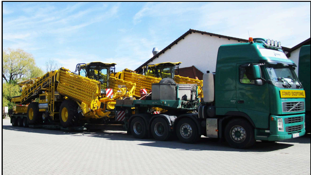
Ordentlicher Tieflader für Straßentransport mit Minimaltransporthöhe
