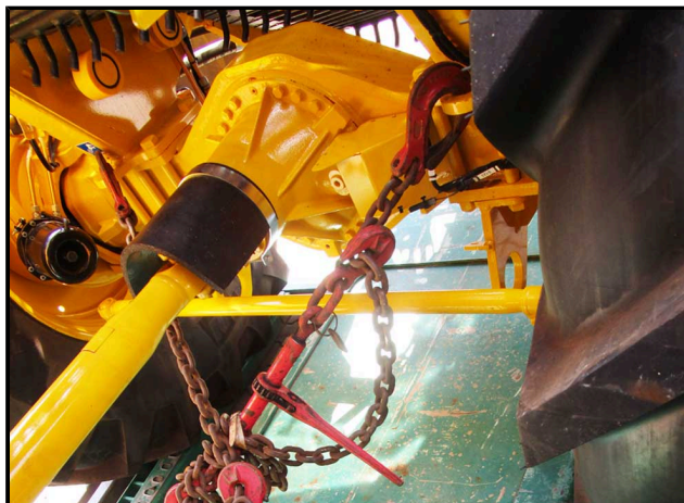
Verzurrung an der Vorderachse
