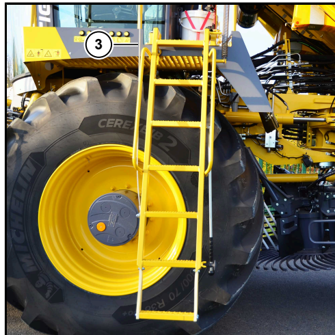
Aufstieg Fahrerkabine in Stellung Straßenfahrt bzw. Rodebetrieb
