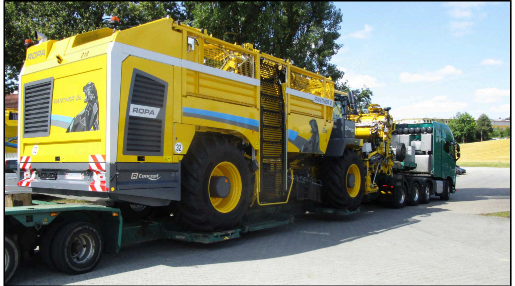
Ordentlicher Tieflader für Straßentransport mit Minimaltransporthöhe
