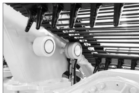
Diesen Bereich regelmäßig prüfen und ggf. reinigen
