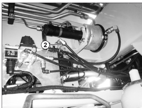
Absperrhahn geöffnet, zum Schließen um 90° drehen.
