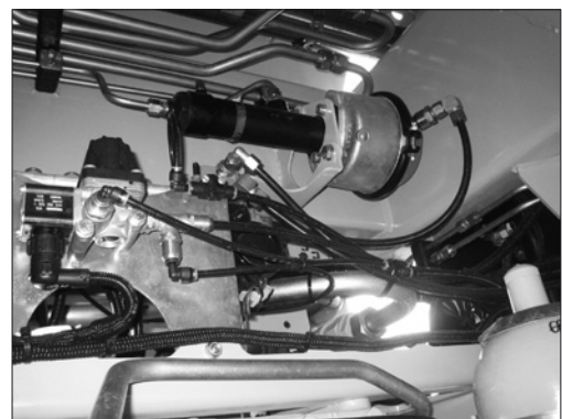
Kombizylinder pneumatisch/hydraulisch (Option nur bei 32 km/h-Version)
