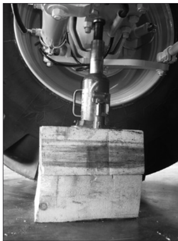
Anheben der euro-Maus4 mit einem hydraulischen Wagenheber Sichern der angehobenen euro-Maus4 durch stabilen Unterbau
