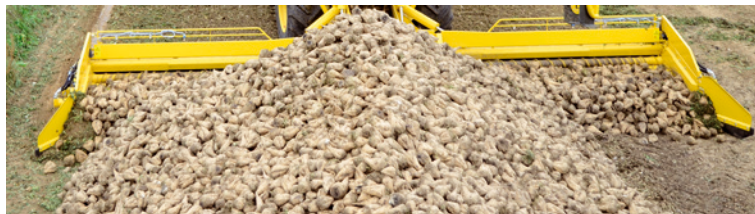
Falsche Einstellung der Räumschilder. Sinnloser Erdhaufen im Bereich der Räumschilder. Zusätzlich falsches Fahren an der Miete. Diese sollte möglichst mittig angefahren werden.
