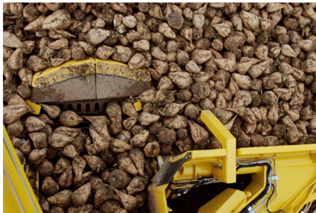
Gleichmäßiger Rübenfluß ohne Stau bei sinnvollem Durchsatz für einen hohen Abreinigungsgrad.
