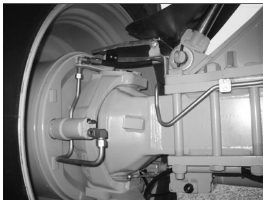
Hinterachse mit hydraulisch betätigter Trommelbremse (Option nur bei 32 km/h-Version)
