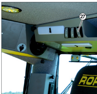
(27) Schalter Aufstiegsbeleuchtung in der Funkkonsole
