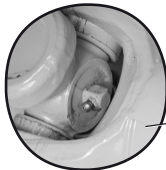
Abbildung beispielhaft: Ein Schmiernippel
