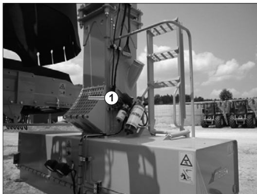
Unterlegkeile am Kraftstofftank
