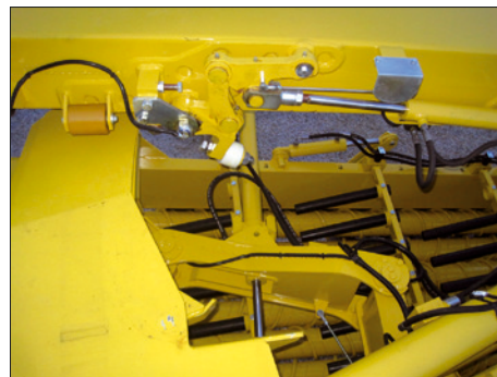
(18b) Verriegelung Gegengewichtsarm in Anschlagstellung
