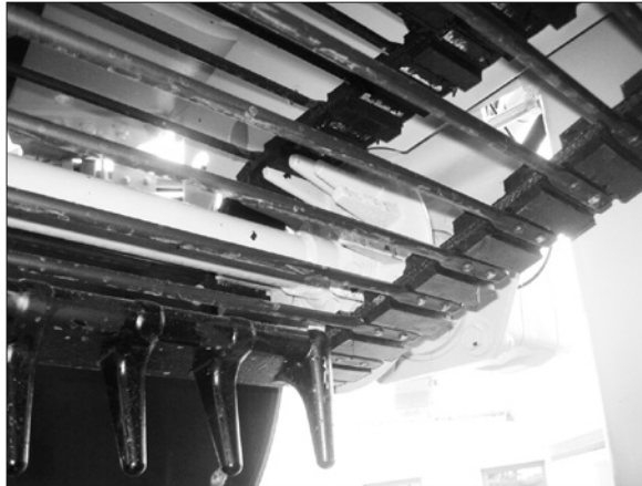
Verschleißgrenze der Fingerscheiben erreicht
