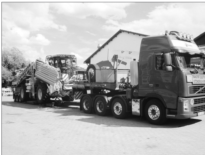
Ordentlicher Tieflader für Straßentransport mit Minimaltransporthöhe
