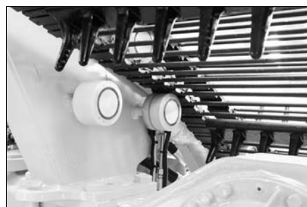
Diesen Bereich regelmäßig prüfen und ggf. reinigen
