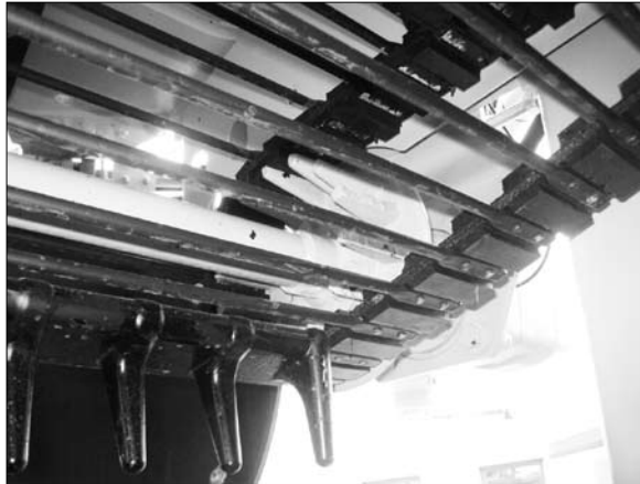
Verschleißgrenze der Fingerscheiben erreicht
