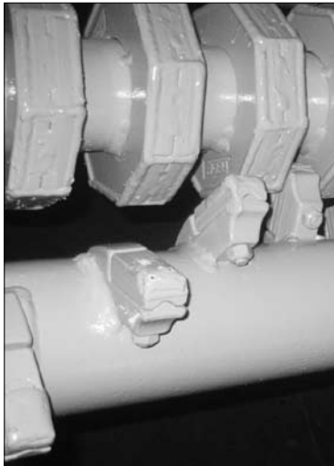
Aufnehmerfinger mit Verschleißplatte
