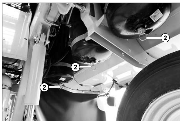
(2) Ablassventil für Kondenswasser
