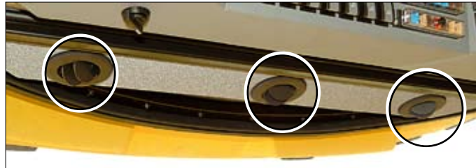
Luftdüsen in der Radiokonsole
