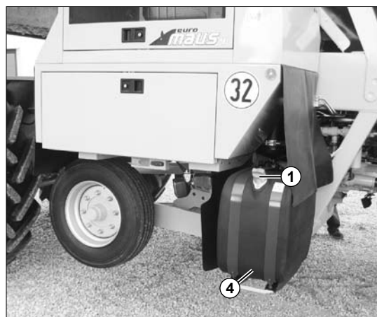
(1) Einfüllstutzen AdBlue® (4) AdBlue®-Tank
