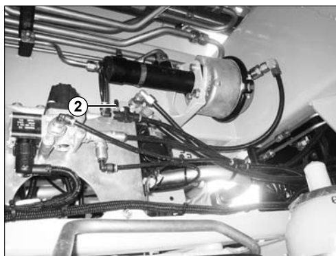
Absperrhahn geöffnet, zum Schließen um 90° drehen.
