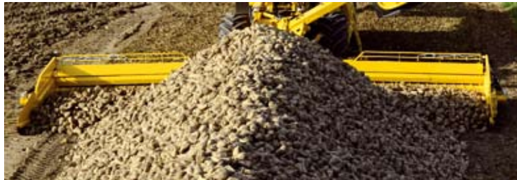
Optimale Einstellung der Räumschilder
