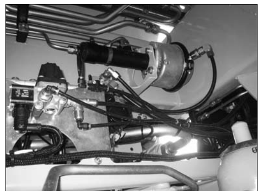
Kombizylinder pneumatisch/hydraulisch (Option nur bei 32 km/h-Version)
