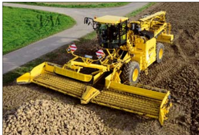
Klappautomatik hat Maschine vorne in diesen Zustand ausgeklappt
