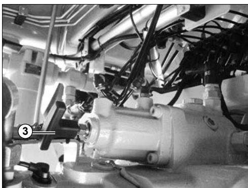
Schaltstange (3) auf der Vorderseite des Untersetzergetriebes
