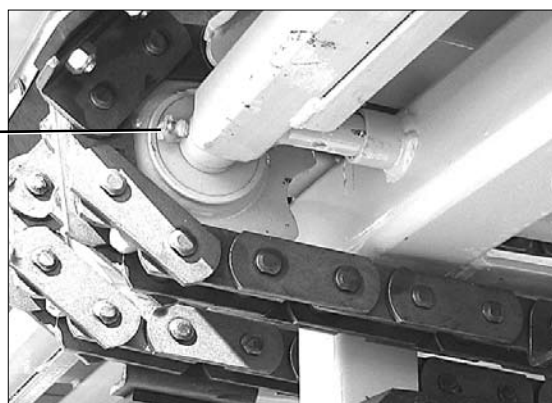
Schmiernippel an den Kratzbodenumlenkrädern 1 Schmiernippel je Umlenkrad
