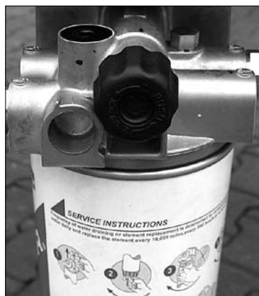
Standard-Vorfilter mit Kolbenpumpe ab Bj. 2008
