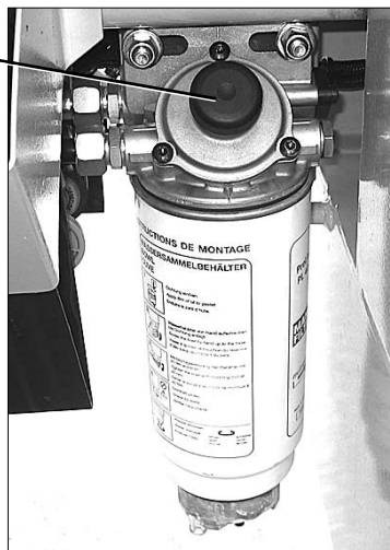
Standard-Vorfilter mit Membranpumpe bis Bj. 2007
