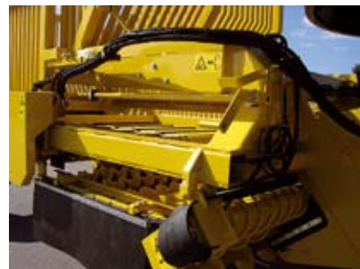
Seitenwände zum teleskopieren des Bunkers hoch geschwenkt.
