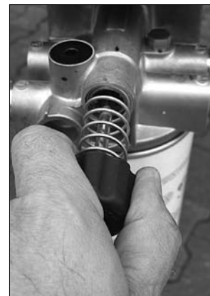
Standard-Vorfilter mit Kolbenpumpe ab Bj. 2008
