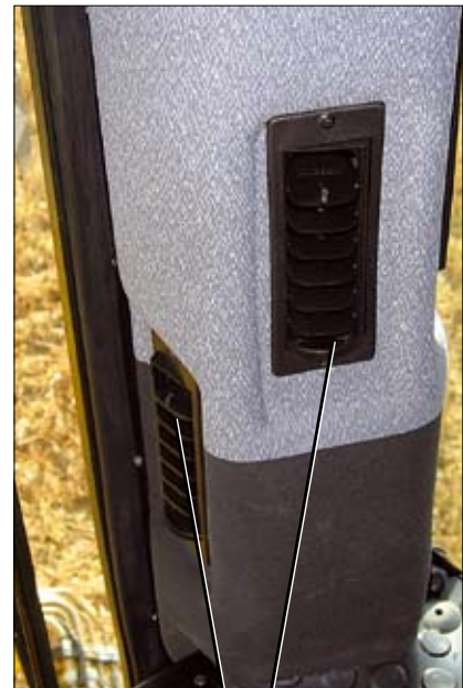
Beispielhaft: Luftdüsen in der rechten A-Säule der Fahrerkabine
