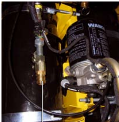
Druckluftkupplung am hinteren Druckluftbehälter (nur bei Version ohne Wassersprühanlage)
