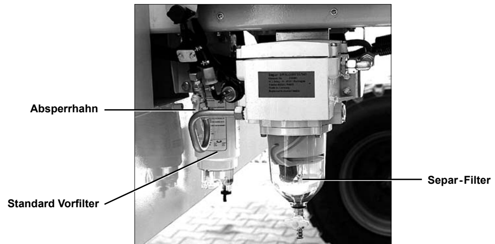
Separ-Filter: nur in Maschinen für GUS-Staaten verbaut
