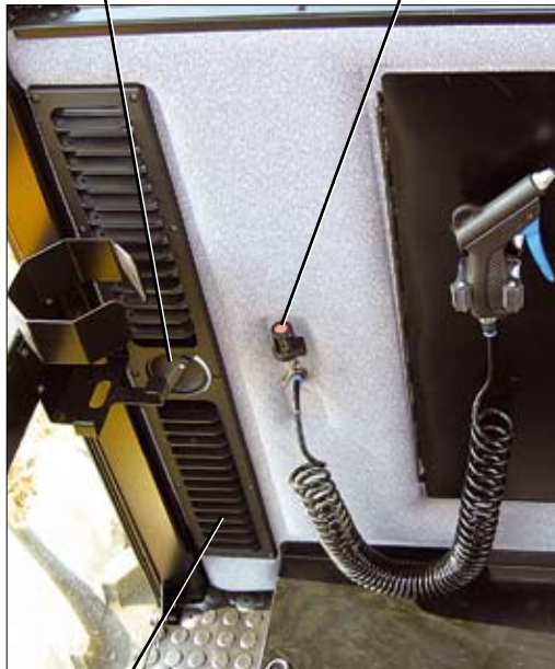
Umluftgitter in der Rückwand
