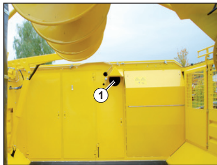
(1) Ultraschallsensor in der Bunkerrückwand.
