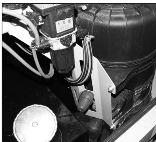
Staubaustragventil in korrekter Position
