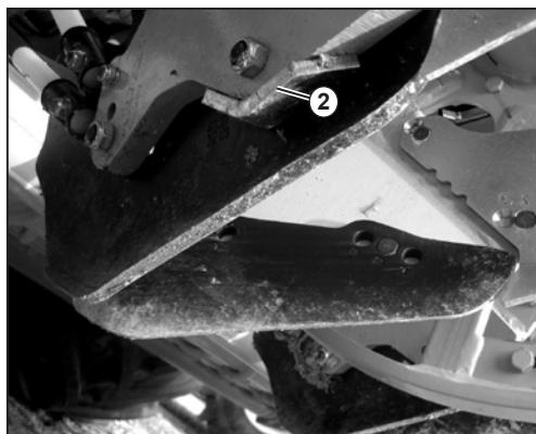
Rodeschar im Neuzustand, Befestigung Loch 2 hinten: untere Bohrung mit Einlaufblech für weiten Scharabstand
