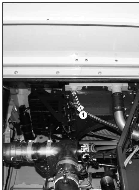
(1) Ablassventil für Kühflüssigkeit am Kühler
