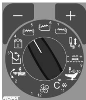
Drehwahlschalter auf Position 5 vorne und hinten heben/senken.
