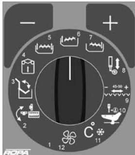
Drehwahlschalter auf Position 6, Bunkerschnecke nur vorne heben/senken.
