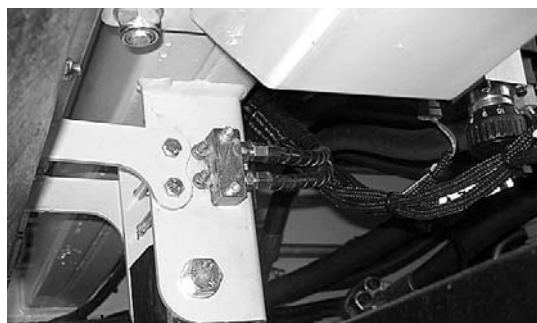
Nippelblock am hinteren linken Tankdrehpunkt.
