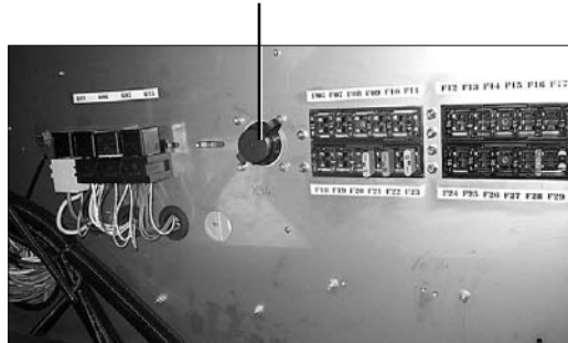
Sicherungen (F06 bis F29) von der rechten Seitenwand der Fahrerkabine zugänglich.
