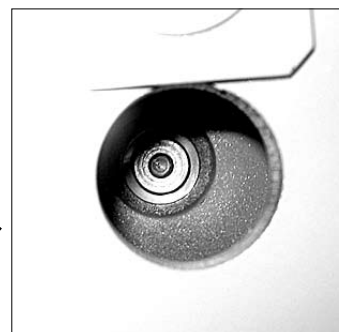
Ölablassschraube; Ansicht von unten.
