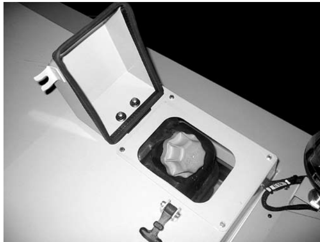
Kühlmitteleinfüllstutzen beim e-T V8-3.
