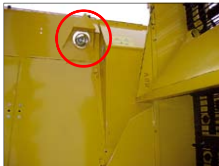
Ultraschallsensor in der Bunkerrückwand.
