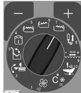
Drehwahlschalter auf Position 7, Bunkerschnecke nur hinten heben/senken.
