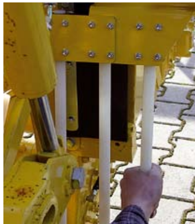
Äußere Leitstäbe ausgehängt.
