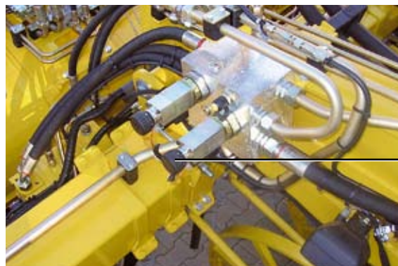
Handrad Notverstellung Blatttellerdrehzahl nur bei PBSH
