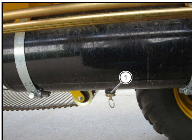
(1) Druckluftbehälter mit Ablassventil
