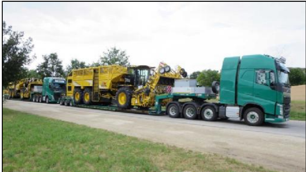
Ordentlicher Tieflader für Straßenstransport mit Minimaltransporthöhe
