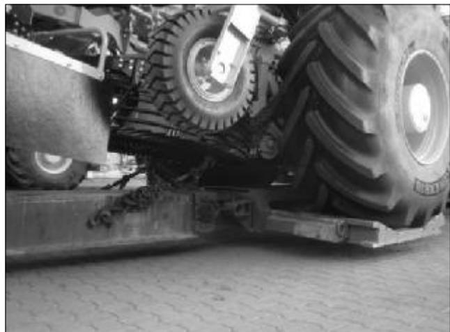
*Verzurrung der Vorderachse am Tieflader mit Spannketten*
