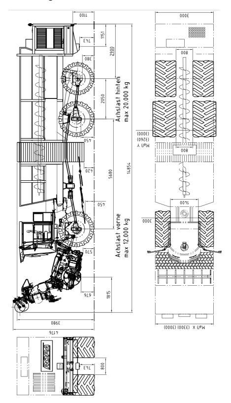
RA45: Maß X und Maß Y: 3000mm RA50: Maß X: 3300mm Maß Y: 3260mm Maschinenbreite
