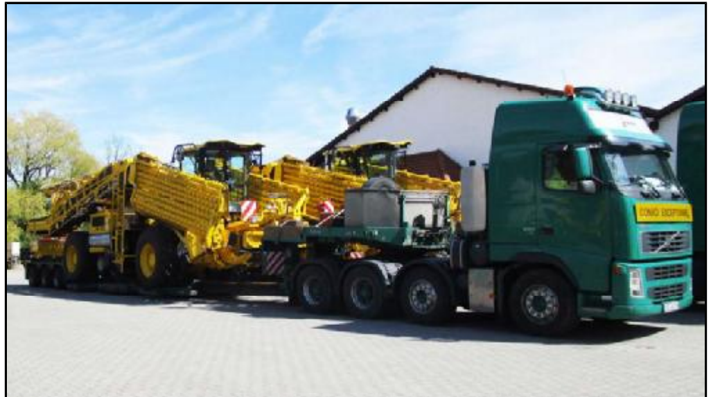
Ordentlicher Tieflader für Straßenstransport mit Minimaltransporthöhe
