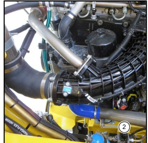
(2) Ablassventil für Kühlfüssigkeit am Kühlwasserrohr
