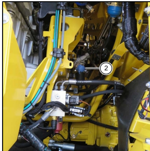
(2) Druckluftkupplung im Motorhaus rechts
