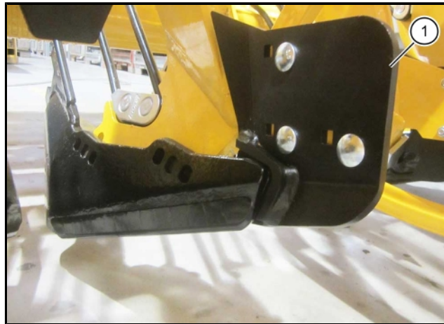
Rodeschar im Neuzustand, Befestigung Loch 2, hinten untere Bohrung
