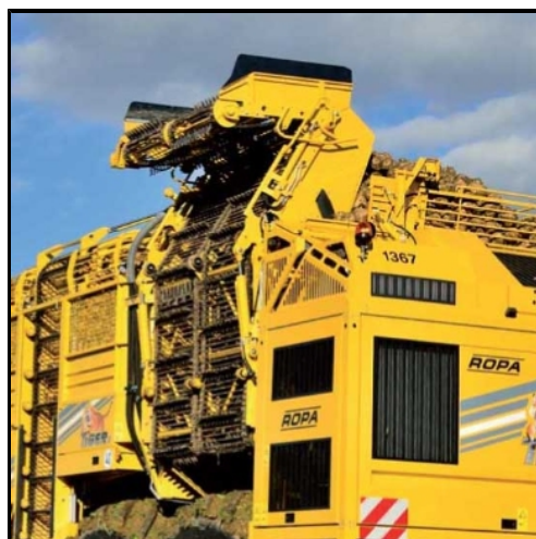
Entladebandknickteil 1 und 2 in Rodestellung
